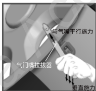
3. 使用气门嘴拉拔器安装传感器总成
